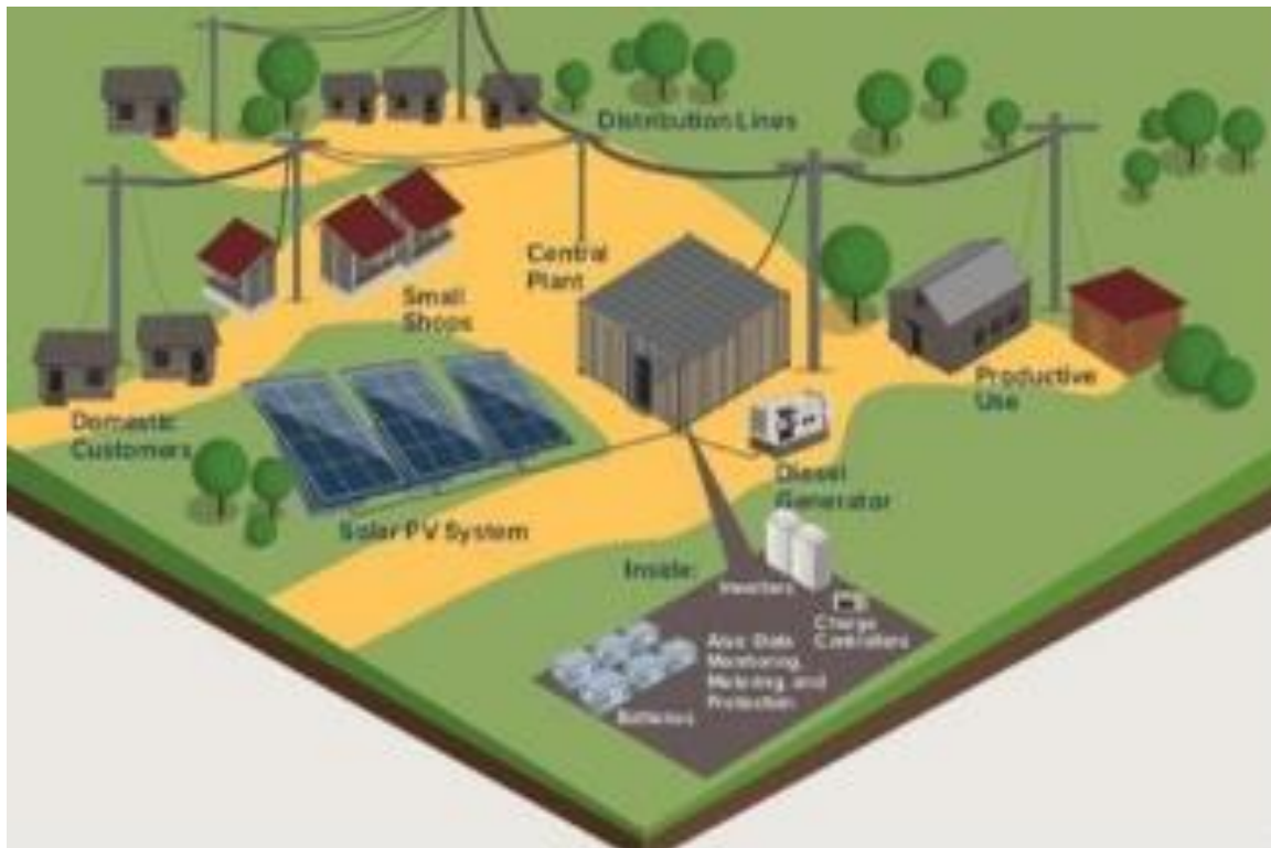
Figure 8: Vue globale du mini-réseau
