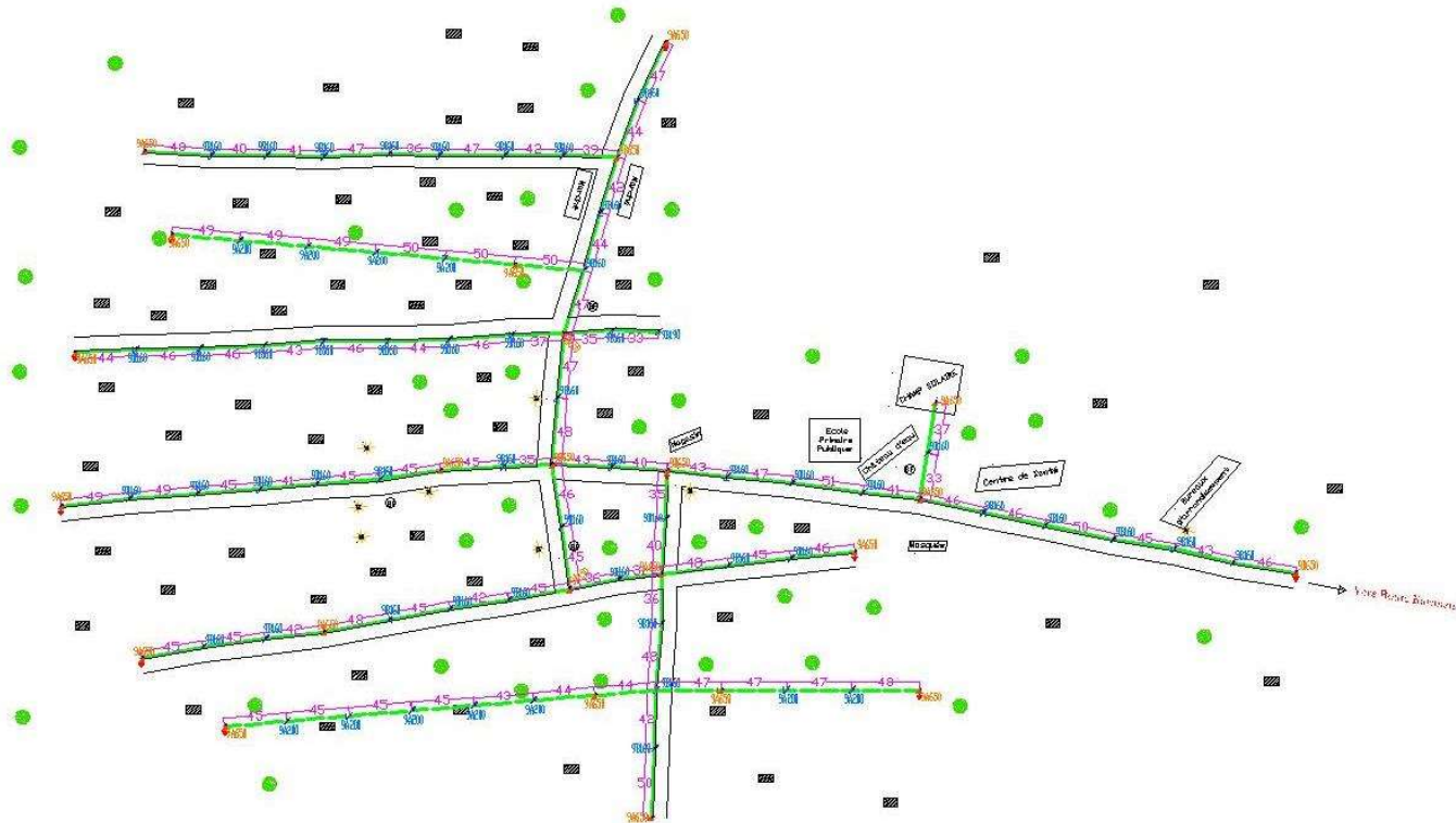
Figure 11 : Réseau électrique de distribution BT de la localité
